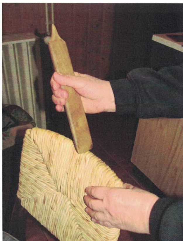
2015-ben húzókával tömítette a széket Nagy Ibolya, hogy ha kiszáradt akkor is tömött és egyenlő legyen. Ez elengedhetetlen művelete a székbefonásnak. (Hargita Péter Árpádné fotói.)
