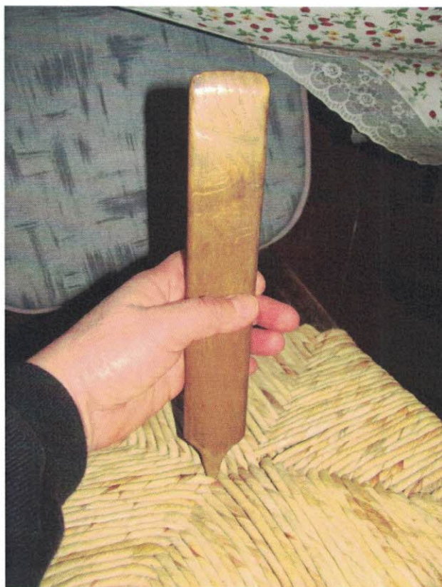
2015-ben húzókával tömítette a széket Nagy Ibolya, hogy ha kiszáradt akkor is tömött és egyenlő legyen. Ez elengedhetetlen művelete a székbefonásnak. (Hargita Péter Árpádné fotói.)
